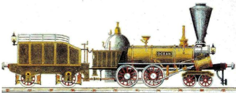
Lokomotiva Ocean (akvarel Sepp Tezak, Graz 1996), tip 4-4-0 s pripetim dvoosnim zalogovnikom.
